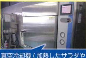
真空冷却機(加熱したサラダや和え物用の食材を冷やします)
